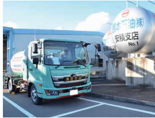
バルクローリーとタンク
